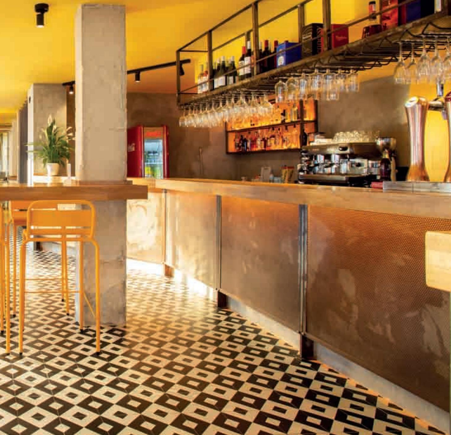
El mobiliario de la trasbarra y el copero suspendido, han sido diseñados por el estudio en tubo metálico y chapa perforada al natural, protegiéndolo con un antióxido transparente úni-
